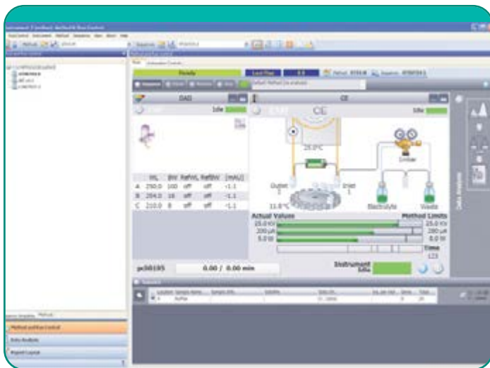
毛细管电泳的化学工作站软件易于使用的图形用户界面展现所有功能，方法设置功能明显改善
